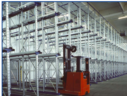
Einfahrregale und Durchfahrregale
